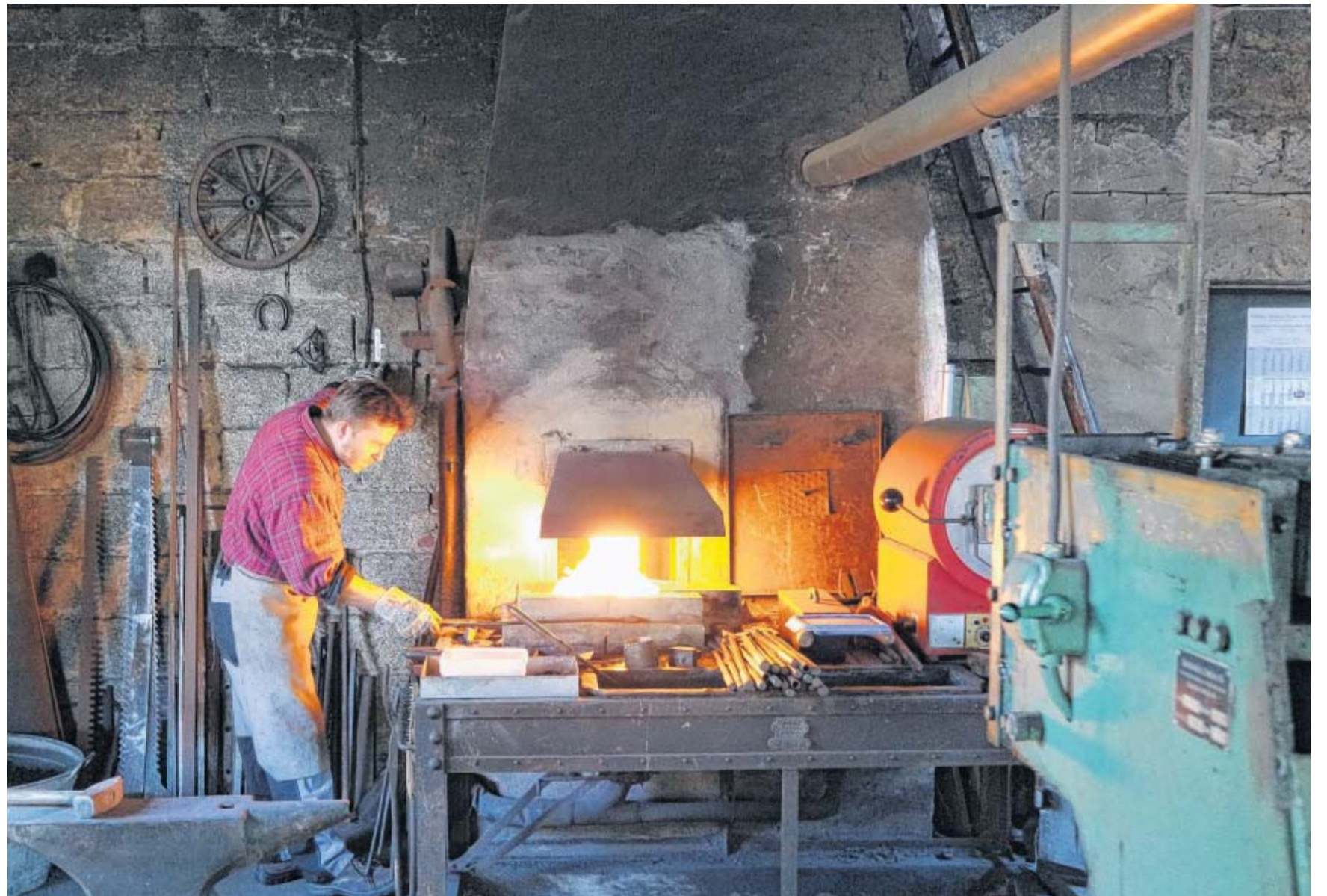
1.150 Grad Celsius: Bei dieser Temperatur nimmt der Damastschmied das Paket verschiedener Stahlschichten aus dem Feuer. Ein Thermometer gibt es natürlich nicht, Hans-Jürgen Kugland muss den richtigen Moment abpassen, damit die Umwandlung der verschiedenen Legierungen zu einer homogenen Stahlverbindung gelingt. FOTO: STEFAN BOES
