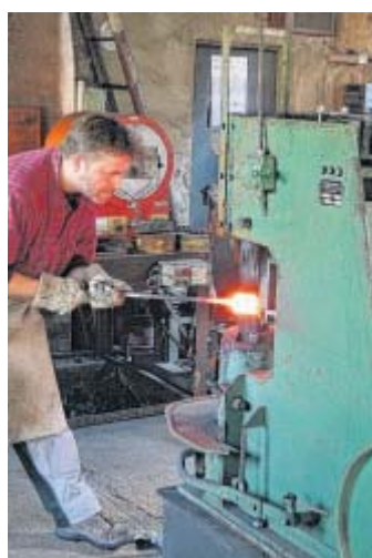
Seit Jahrzehnten im Einsatz: Der Federhammer schlägt krachend auf das glühende Stahlpackchen ein. Rechts die Werkstatt, in der schon der Vater von Hans-Jürgen Kugland als Schmied wirkte.
