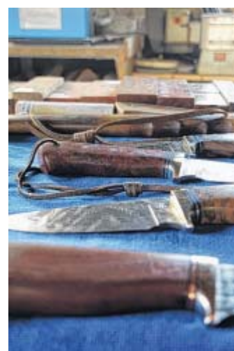
Schmiedekunst: Hans-Jürgen Kugland fertigt in von Langsamkeit geprägter Arbeit Jagdmesser, die wegen ihrer besonderen Klingensform das Aufbrechen des Wildes bei der Jagd erleichtern. Die Herstellung eines Messer kann bis zu einhundert Stunden dauern. FOTOS: STEFAN BOES
