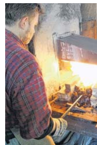
Schmiedekunst: Hans-Jürgen Kugland fertigt in von Langsamkeit geprägter Arbeit Jagdmesser, die wegen ihrer besonderen Klingensform das Aufbrechen des Wildes bei der Jagd erleichtern. Die Herstellung eines Messer kann bis zu einhundert Stunden dauern. FOTOS: STEFAN BOES
