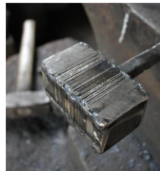
Mischung harter und elastischer Stähle im Ausgangspaket, das auf 1.150 Grad Celsius erhitzt wird.
