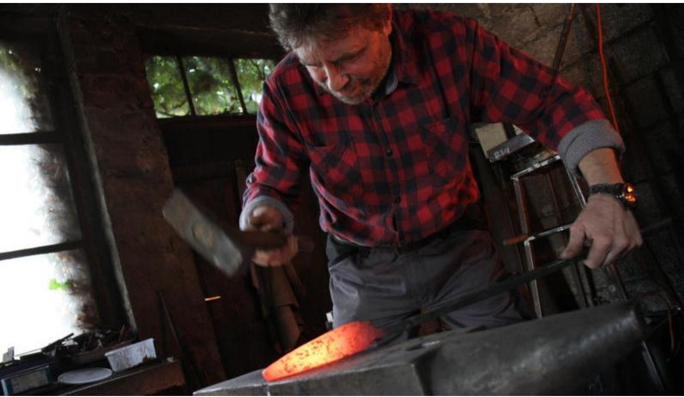
Mit schnellen und harten Schlägen gelingt Hans-Jürgen Kugland die Verbindung der einzelnen Stahlschichten.
