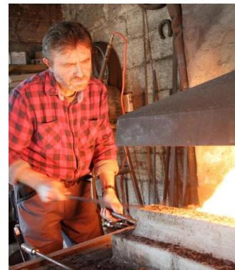
Erkaltet der Metallblock, kommt er wieder ins Schmiedefeuer.
