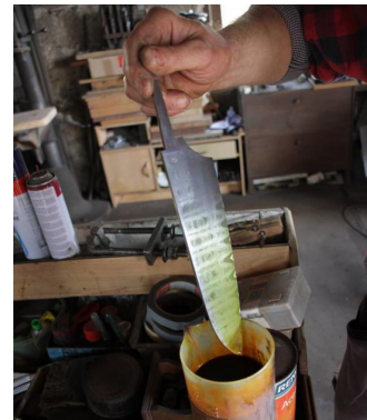
Beim Ätzen verfärben sich Stahlschichten nach Kohlenstoffanteil und Legierung hell und dunkel.
